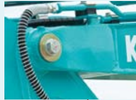
Forjado delantero del boom
