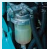
Pre filtro de combustible con una función de separador de agua
